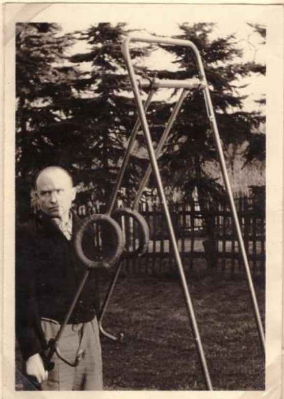
2) Ausschnitt daraus. Schwingstangen (Handgriffe verstellbar), Schwingachse mit Federn, Stützpfeosten.
