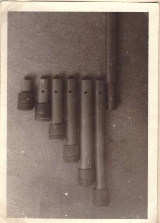
4) An den Enden der Stützpfeosten lassen sich verschieden lange Füße je nach Körperlänge anstecken.
